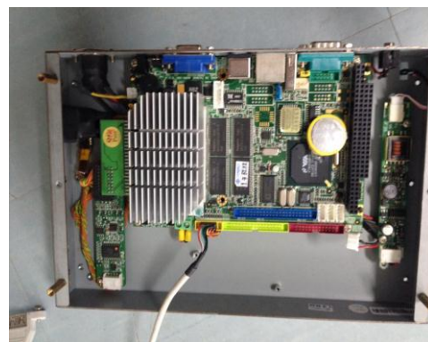
รูปที่ 2 เครื่องคอมพิวเตอร์ระบบฝังตัวที่ใช้ในการพัฒนาเครื่องชุมสายไอพี
