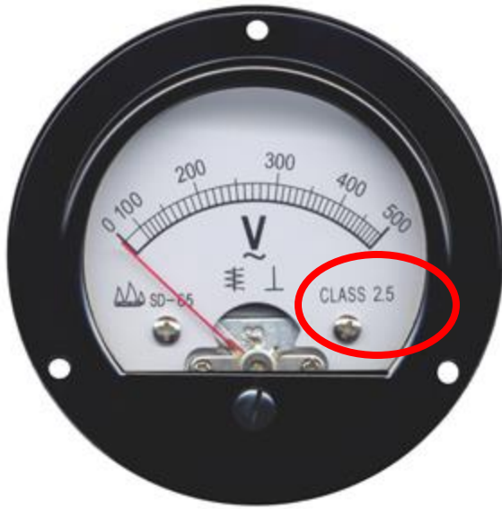
ภาพที่ 2.1 แสดงหน้าปัดเครื่องวัด แบบขดลวดเคลื่อนที่
