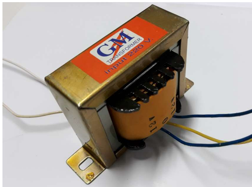
ภาพที่ 2.38 ลักษณะหม้อแปลงไฟฟ้า
