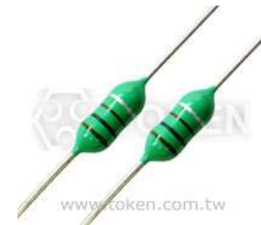
ภาพที่ 2.28 ตัวอย่างตัวเหนี่ยวนำแสดงค่าด้วยแถบสี
