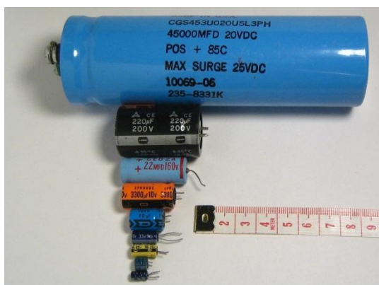
ภาพที่ 2.4 ตัวเก็บประจุชนิดอิเล็กโทรไลต์
