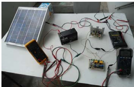
รูปที่ 6 การทดลองวงจรบัส-บูสต์ คอนเวอร์เตอร์ ชาร์ตแบตเตอรี่จากโซลาร์เซลล์
