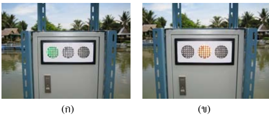
รูปที่ 7 LED แสดงผลสถานะของคุณภาพน้ำ (ก) สถานะปกติ LED แสดง สีเขียว (ข) สถานะเฝ้าระวัง LED แสดงสีเหลือง
