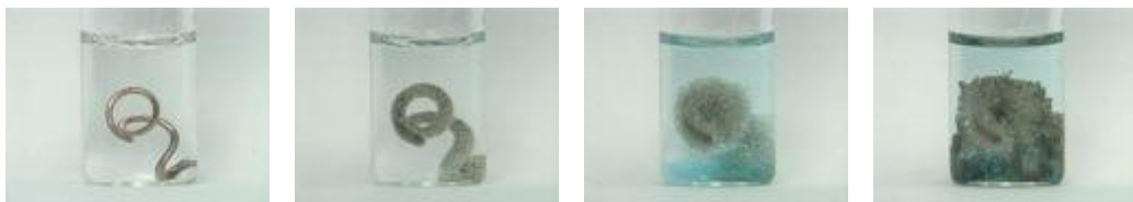
ภาพที่ 8.1 ปฏิกิริยาออกซิเดชันของลวดทองแดงในสารละลายซิลเวอร์ไนเทรต
