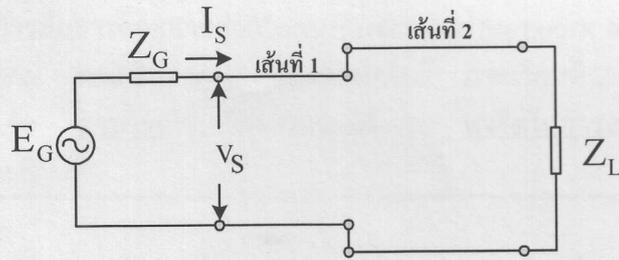
สายส่งเส้นที่ 1 มีค่า  $Z_0 = 531 \angle 10^\circ \Omega$ ,  $\gamma = 3.6 \times 10^{-6} + j6.11 \times 10^{-6} \text{ m}^{-1}$
