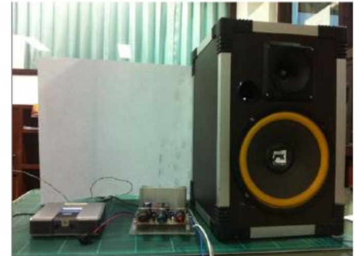
รูปที่ 10 จุดกระจายสัญญาณแบบภายนอกด้วยเครื่อง ATA รุ่น Linksys PAP2T
