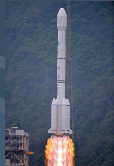
รูปที่ 8 จรวดลองมาร์ช 3บี เป็นจรวด 3 ท่อน ท่อนล่างสุดมีจรวดเสริม 4 เครื่อง
