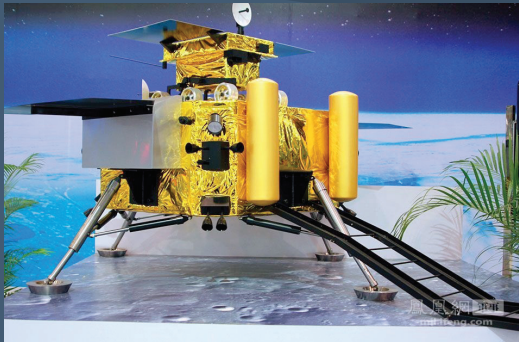
รูปที่ 5 ยานฉางเอ๋อ 3 แสดงอยู่ทางด้านบน ซึ่งจะลงจากยานทางบันไดลิค้ำ
