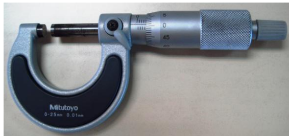
ภาพที่ 1.1 ไมโครมิเตอร์ใช้วัดความหนาของวัตถุแสดงผลเป็นแบบขีดสเกลสามารถวัดได้ละเอียดถึง 0.01 มิลลิเมตร
