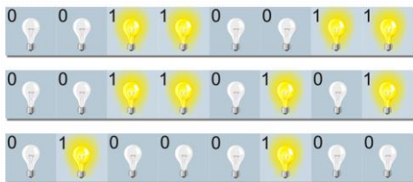
ข้อมูลที่อยู่ในรูปของตัวเลขฐานสอง (Binary Digit)
