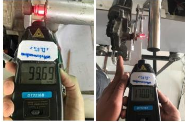
การทดสอบหาความเร็วรอบของมอเตอร์สกรู โดยใช้เครื่องวัดความเร็วรอบมอเตอร์ (Digital Tachometer) รุ่น DT2236B
