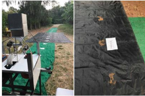
การทดสอบหาความเร็วรอบของมอเตอร์สกรู โดยใช้เครื่องวัดความเร็วรอบมอเตอร์ (Digital Tachometer) รุ่น DT2236B
