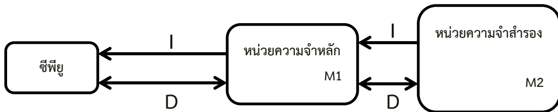
ภาพที่ 6.16 แสดงลำดับชั้นของหน่วยความจำแบบ 2 ระดับ คือ หน่วยความจำหลัก และหน่วยความจำสำรอง
