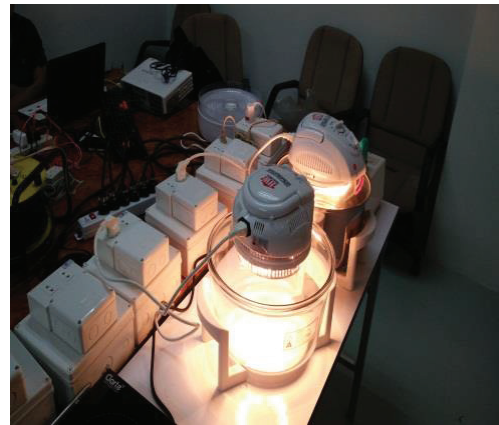
รูปที่ 6 การทดสอบการทำงานของอุปกรณ์ชดเชยตัวประกอบกำลังเมื่อต่อร่วมกับภาระทางไฟฟ้า
